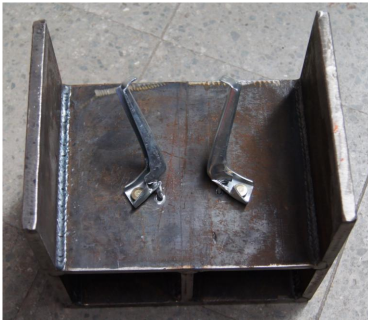
Figura B.2 Conectores luego del ensayo de corte.
